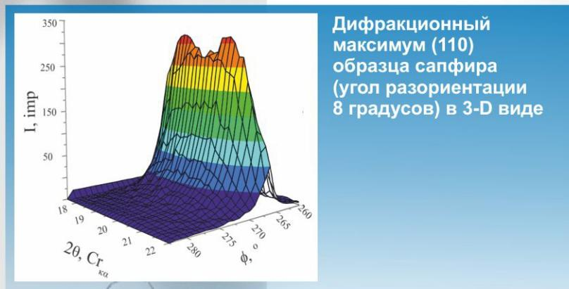
Дифракционный максимум (110) образца сапфира (угол разориентации 8 градусов) в 3-D виде
