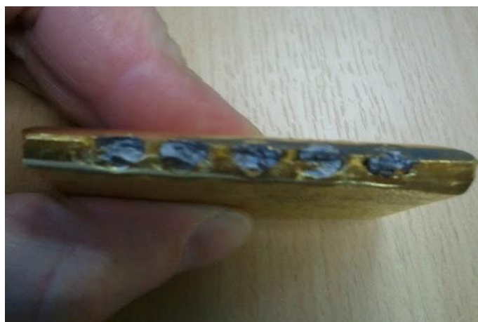
Рис.2. Поддельный слиток золота (внутри вольфрам).
