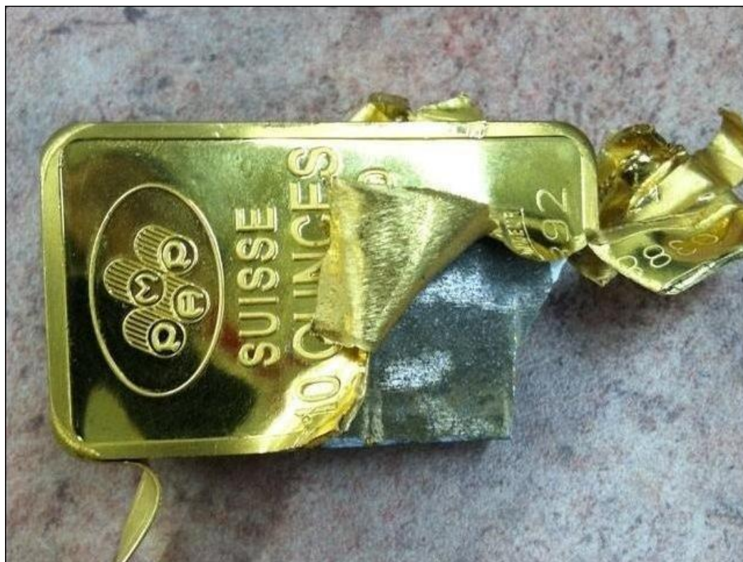
Рис.3. Поддельный слиток золота (внутри вольфрам).
