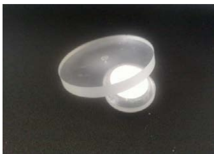
Рисунок 109 – Фотография кюветы, заполненной материалом эталона, и пластины для выравнивания
