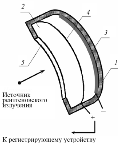
Рисунок 13 – Схема координатно-чувствительного детектора:
