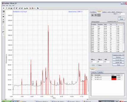
Рисунок 154 – Модуль Обработка , вкладка Анализ . Выделение вручную рамкой отдельного пика (а) и наложение штрих-диаграммы на выделенный пик (б)
