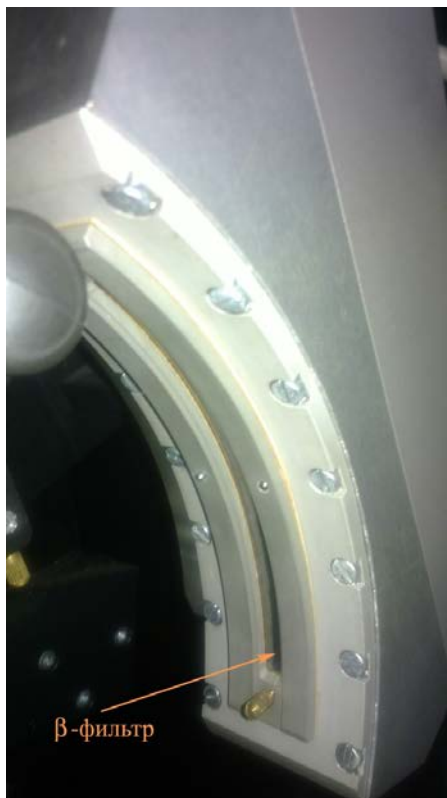
Рисунок 15 – \beta -фильтр, прикрепленный к детектору рентгеновского излучения
