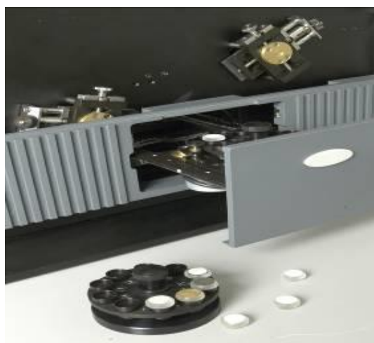
Рис.4. Столик автоматического сменщика и сменный диск с пробами
